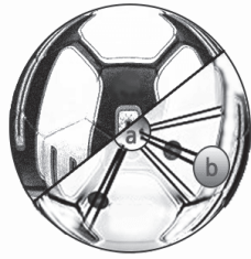
그림 6. 축구 스마트볼 (a : 컨트롤보드, b : 센서)
