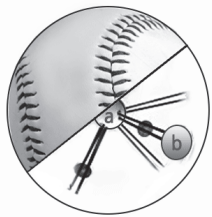
그림 7. 야구 스마트볼 (a : 컨트롤보드, b : 센서)
